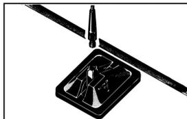
4. Ajustez le couvercle de protection et pressez fortement. Vous pouvez maintenant installer le fouet de l'antenne.
